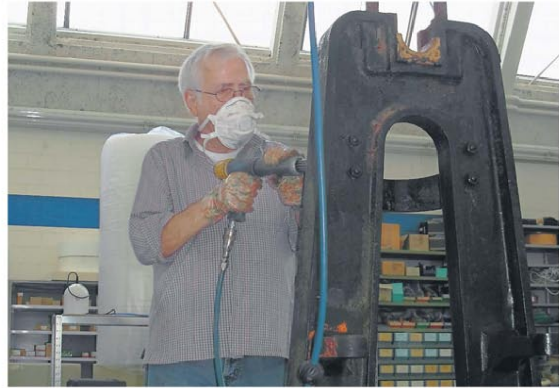
Bei der Rost- und Farbentfernung wird ein Atemschutz getragen.
